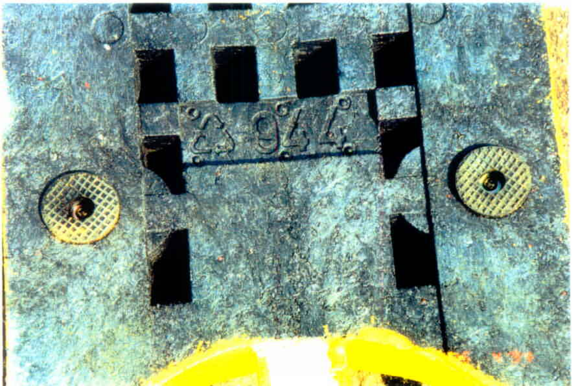
Bild 42: Unterseite eines LS-Elementes nach beiden Prüfdurchgängen
