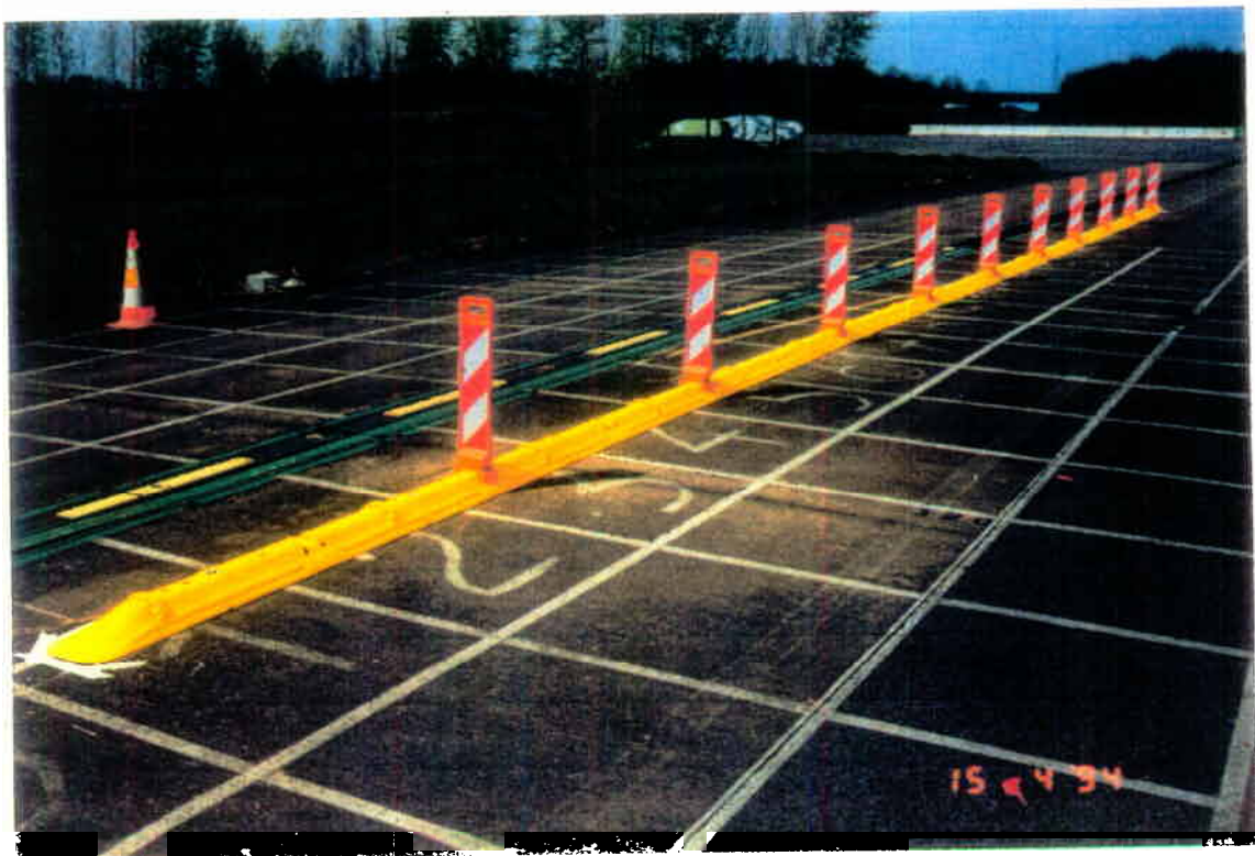
Bild 24: Ausgangsposition für Überfahrt 0 ° mit Bremsung
