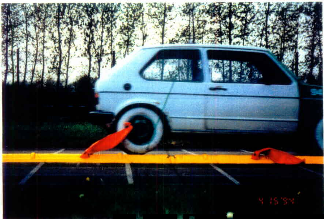
Bild 40: Flexibles Verformen der Leitboys Nr.5 und 6 während der Überfahrt mit Bremsung
