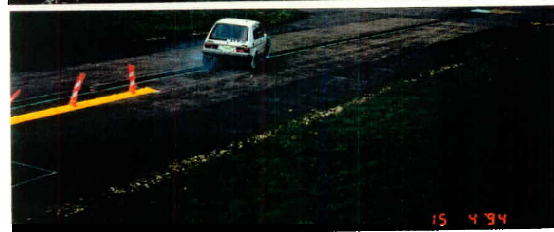
Bilder 29-32: Bildfolge der Überfahrt mit Bremsung \Delta t = 0,2 \text{ s} (Teil 2)
