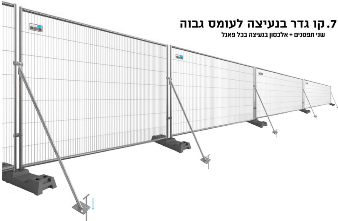
7 [א]. קו גדר בנעיצה לעומס גבוה שני תפסנים לכל פאנל + בזנט ואלכסון בנעיצה לסירוגין
